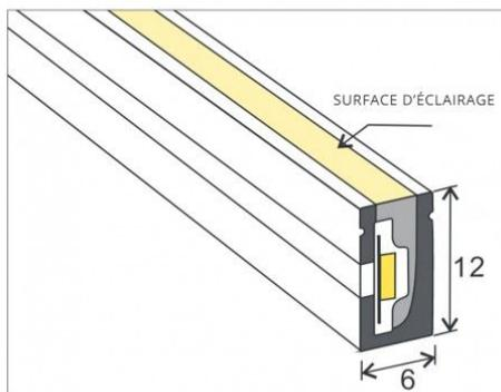
**Tube Néon Flex pour ruban LED** en silicone. Vendu à la coupe. Longueur maximale réalisable (sans coupe) = 100 m. Dimensions: 6 x 12mm. Ruban LED compatible (largeur): 5-8mm / IP20. Découvrez les nombreux avantages de ce nouveau type de profilé.
