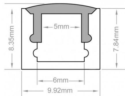
**Profilé aluminium ultra étroit en applique pour ruban LED.** Finition aluminium anodisé.
