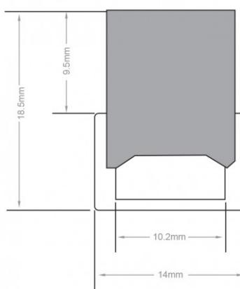
**Profilé PVC pour ruban LED encastré.** Finition PMMA blanc . 14 mm x 18.5 mm - Pour ruban LED jusqu'à 10 mm de largeur.
