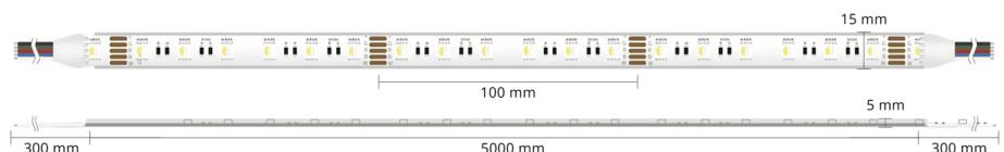
**Ruban LED 24V RGB + Blanc chaud.** Très forte luminosité. Utilisation extérieure IP68 - LED 5050 - 19,2W/m pour 60 LED/m sous 24 volts.
