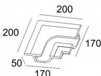
Ce profilé en plâtre est à encastrer sur une plaque en plâtre au mur ou dans un faux plafond type BA13.
