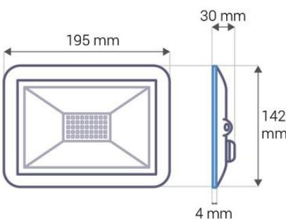
**Projecteur LED extra plat 30 W.** Équivalent halogène 300 watts.
