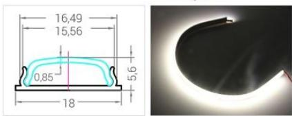
**Profilé ruban LED souple.** Aluminium, finition anodisée.
