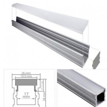
**Profilé LED encastrable carrossable au sol et murs.** Aluminium. 26 mm x 26 mm - Pour rubans de 17 mm de large max.
