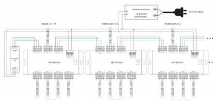
Chaque splitter à une limite maximum de courant de 30 ampères, néanmoins, vous pouvez contourner cette limite en branchant le "+" et le "-" de vos rubans LED SPI directement à alimentation supplémentaire (les "-" , "data" et "clock" de vos rubans LED SPI restent branchés au splitter).
