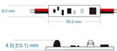
L'interrupteur est équipé d'un adhésif double-face (3M©) pour une fixation rapide sur toute surface plane, notamment à l'intérieur d'**un profilé à diffuseur en plastique** (transparent ou givré). Il est précablé à chaque extrémité pour une connexion rapide avec le ruban LED et l'alimentation.
