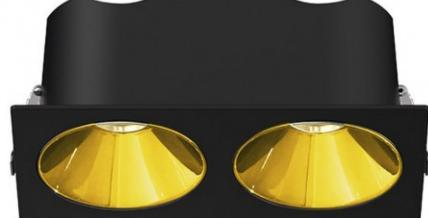
Le **spot LED encastrable Miror** fonctionne en **Très Basse Tension de Sécurité (TBTS)** via un **driver en classe III**, alimenté en **39 V DC**. Son **indice de protection IP44** garantit une protection contre les projections d'eau, ce qui permet son installation en toute sécurité dans le **volume 2 des salles de bains**, conformément à la norme **NFC 15-100**.
