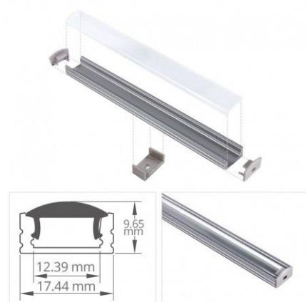
**Profilé aluminium pour ruban LED.** En applique ou encastrable. 17,4 mm x 9,6 mm - Angle de diffusion : 60° - Compatible avec les rubans LED ne dépassant pas 12 mm de largeur.
