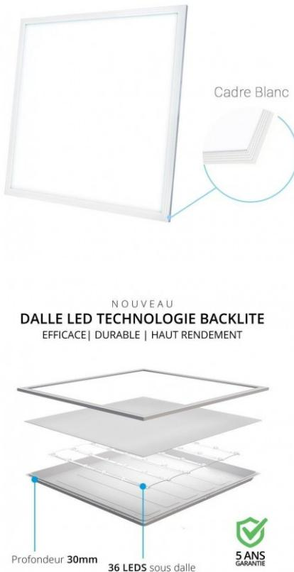
**Dalle LED UGR<23 60x60 120lm/W.** Finition acier laqué blanc satiné. 5000 K : blanc neutre | Dimensions : 595x595mm | 120lm/W | Diffusion : 115° | Diffuseur anti-jaunissement | 230V | Driver inclus.
