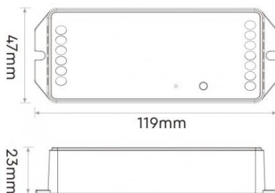
Le contrôleur MiBoxer 5 en 1 offre une flexibilité d'utilisation impressionnante. Avec une **puissance de sortie maximale de 960W**, il permet de piloter l'éclairage de divers types de rubans LED allant du **12 au 48 volts**, dans des environnements comme des maisons, des commerces ou des hôtels.
