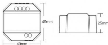
230V derrière un bouton poussoir, installé dans une boîte d'encastrement d'au moins 50 mm de profondeur. Une infinité de boutons poussoir peuvent être ajoutés en dérivation.
