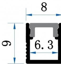
L'installation s'adapte à tous types de supports grâce aux pattes de fixation incluses (2 par mètre) ou peut être réalisée par simple collage. Pour les profilés de 2 mètres et plus, la livraison est assurée par un prestataire spécialisé dans le transport de produits de grande longueur (France Express).
