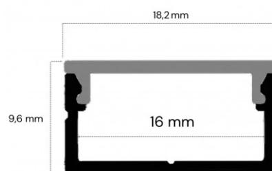
**Profilé noir en applique pour ruban LED.** Ce profilé en aluminium, est également disponible en blanc et en finition aluminium. Dimensions : 18mm x 9,6 mm, compatible avec rubans LED jusqu'à 16mm de large.
