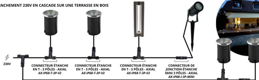
BRANCHEMENT 230V DANS LA TERRE EN CASCADE
