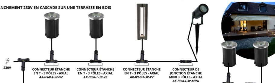
BRANCHEMENT 230V DANS LA TERRE EN CASCADE
