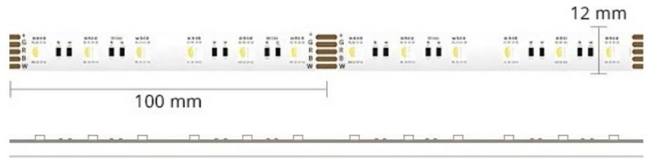
**Ruban LED RGB + Blanc chaud, vendu au mètre.** Forte luminosité. Utilisation intérieure IP20 - LED 5050 - 19,2 W/m pour 60 LED/m sous 24 volts.
