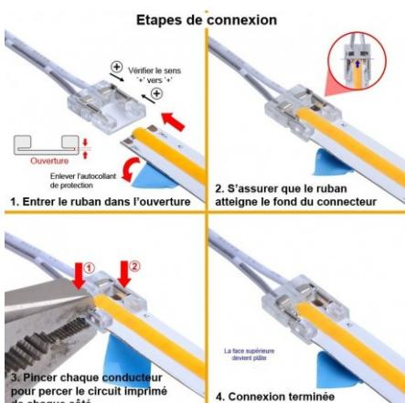
Exemple : avec un connecteur 4A en 24V, vous pouvez raccorder jusqu'à 96W (soit 3 m de ruban LED 19,2W).
