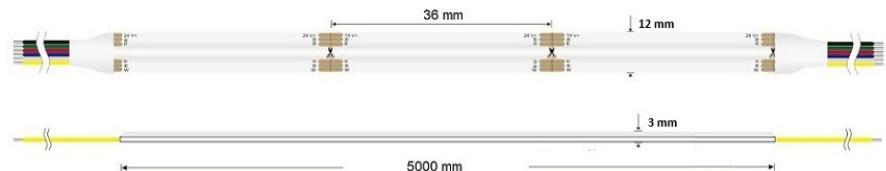
**Ruban LED COB RGB+CCT de 21W/m.** 5 mètres - 840 LED/m - 24V - IP20 : intérieur uniquement.
