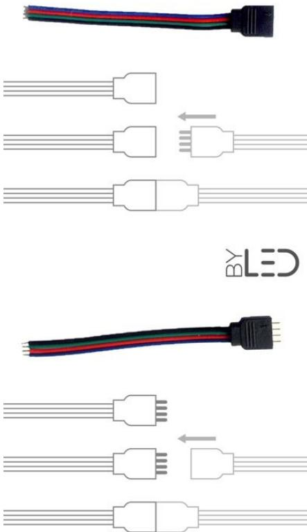
Le connecteur à 4 broches Femelle permet de faire une jonction démontable avec un connecteur mâle.
