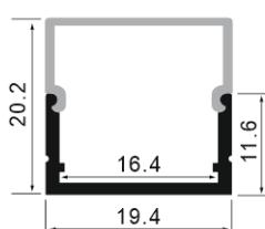
rubans avec moins de LED, vous bénéficieriez d'un éclairage uniforme sans points lumineux visibles, grâce à la profondeur du profilé qui diffuse efficacement la lumière.
