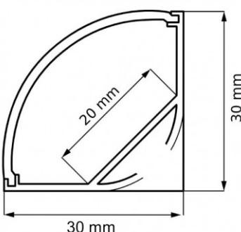
Ce profilé A44 en forme d'angle droit s'adaptera parfaitement dans un angle à 90°. Les clips de fixation ultra fins en inox permettent une fixation discrète et rapide.
