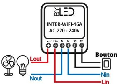
**Ce mini module Wi-Fi Tuya** permet d'allumer, d'éteindre et d'automatiser votre éclairage ou vos appareils électriques 230V jusqu'à 16A (soit 3700 watts maximum), depuis n'importe où, tout en conservant l'utilisation de vos interrupteurs ou de vos boutons poussoirs lorsque vous êtes chez vous. Il se place dans la boîte d'encastrement derrière votre interrupteur grâce à sa petite taille : 41x41x20 mm .
