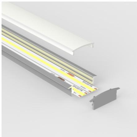
**Large profilé encastrable pour ruban LED.** Matière : Alu 30,3 mm x 9,75 mm - Peut intégrer 2 rubans simples côté à côté (max. 2 x 8 mm) ou un ruban jusqu'à 19 mm maximum.
