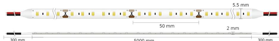
**Bandeau LED étroit, lumière bleu haute fidélité, 5 mètres.** Teinte: bleu. LED 2835E - Installation en intérieur ou en extérieur : IP65 – 120 LED / mètre pour une puissance de 9,6 Watts/m - 24 Volts.
