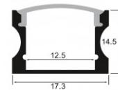
**Profilé de ruban LED C33.** Profilé aluminium en applique avec finition de protection anodisée. Ce profilé est également disponible en noir et en blanc. 17mm x 14,5 mm - Largeur maximum de ruban LED autorisée : 12mm.
