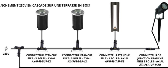
BRANCHEMENT 230V DANS LA TERRE EN CASCADE
