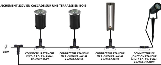
BRANCHEMENT 230V DANS LA TERRE EN CASCADE
