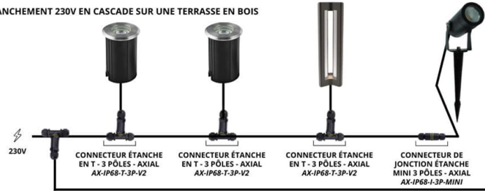
BRANCHEMENT 230V DANS LA TERRE EN CASCADE
