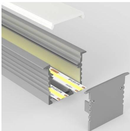
**Profilé encastrable pour ruban LED Large** il peut accueillir deux rubans. 44 mm x 35 mm – Compatible avec les rubans larges de 31 mm max. ou 2 rubans de 15 mm de large max.
