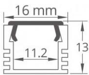
**Profilé pour bandes LED en aluminium.** Qualité Premium. 16mm x 13 mm - Pour largeur de ruban LED de 11mm max.
