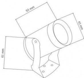
**Spot LED extérieur sur piquet - 5 WATTS.** Utilisation extérieure, étanche IP65 - Rayon de diffusion de 40° - 12V.
