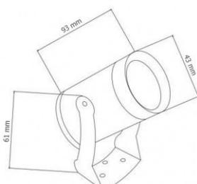
Le niveau de protection IP65 garantit le fonctionnement de ce spot LED dans tous types d'espaces extérieur, il résiste à la **pluie, à l'humidité ambiante et aux conditions climatiques exigeantes**. De plus, sa structure en aluminium renforce sa robustesse face aux chocs tout en assurant une excellente dissipation thermique, évitant ainsi tout risque de surchauffe.
