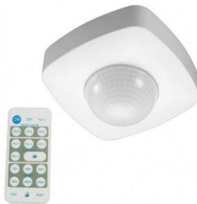
Ce détecteur de mouvement est destiné au plafonds de grande hauteur, en intérieur. Équipé de 3 cellules infrarouge sa portée peut atteindre 20 mètres. Il réagit aux émissions thermiques (infrarouges) issues des personnes (ou animaux) en mouvement dans la zone de détection du capteur. Quand le capteur détecte un passage dans sa zone, la lampe que vous lui avez raccordée s'allume. Elle s'éteint automatiquement après la fin de la détection de présence (durée réglable).
