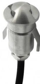
**Balise LED encastrable au sol 0,6W.** En inox 304 et vitre en verre. Diamètre : 30 mm - Étanche IP67 - Diffusion double direction - 12V DC.
