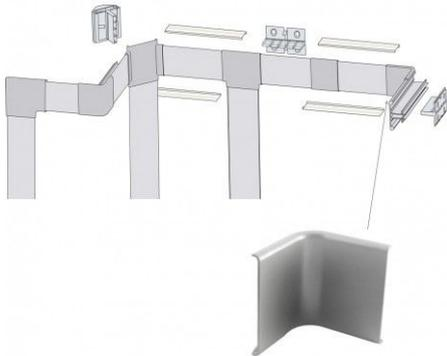
**Angle entrant pour profilé LED aluminium corniche 2 directions.** En polycarbonate.
