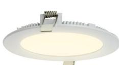
La **dalle LED encastrable Sunny 9W** fonctionne en **Très Basse Tension de Sécurité (TBTS)** via un **driver en classe III**, alimenté en **32 V DC**. Grâce à son **indice de protection IP44**, elle résiste aux projections d'eau et peut être installée en toute sécurité dans le **volume 2 des salles de bains**, conformément à la norme **NFC 15-100**.
