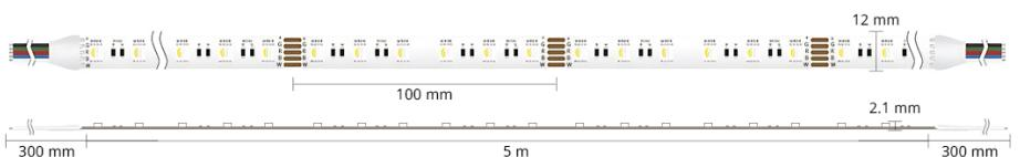
**Ruban LED RGB + Blanc chaud.** Forte luminosité. Utilisation intérieure IP20 - LED 5050 - 19,2 W/m pour 60 LED/m sous 24 volts.
