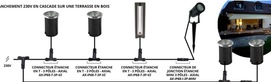
BRANCHEMENT 230V DANS LA TERRE EN CASCADE
