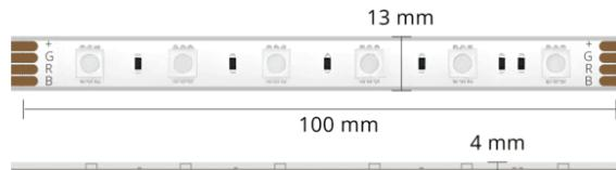
**Ruban LED RGB vendu à la coupe.** 14,4 W/m - 60 LED/m - 24V - IP68 (extérieur et immersion dans l'eau) - LED5050.
