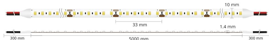
**Ruban LED ambré de 14,4 W/mètre.** IP20 (utilisation en intérieur uniquement) - 180 LED/m - LED 2835+ - 24V.
