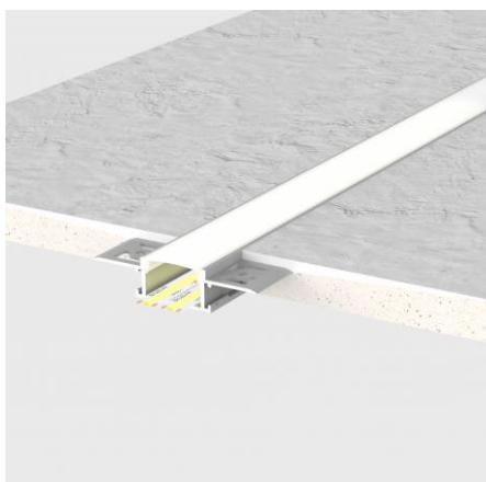
**Profilé encastrable à plâtrer pour ruban LED large ou double.** Pack "prêt à poser" avec diffuseur givré et embouts de finition pour intégrer un ruban LED simple ou double allant jusqu'à 20,7mm de large.
