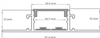
Ce profilé est disponible en longueur de 1m, 2m et 3m (incluant 2 embouts de finition par mètre et un diffuseur givré de la bonne longueur).
