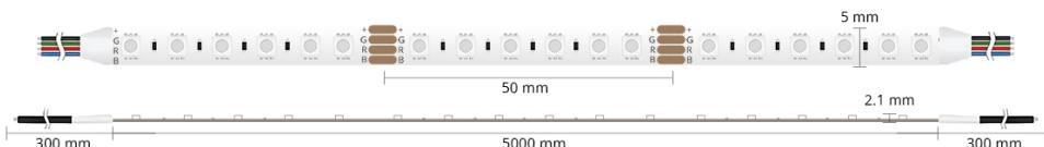
**Bandeau LED étroit, rouleau de 5 mètres, infinité de couleurs réglable avec un contrôleur et une télécommande.**
