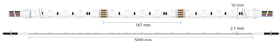
**Ruban LED RGB 5 mètres.** Infinité de couleurs réglable avec [un contrôleur et une télécommande RGB](#) (non fournies). LED Epistar 5050 - 24V - Non étanche IP20 - Disponible en 7,2W/m.
