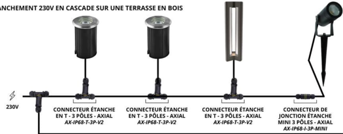
BRANCHEMENT 230V DANS LA TERRE EN CASCADE
