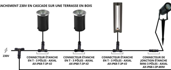
BRANCHEMENT 230V DANS LA TERRE EN CASCADE
